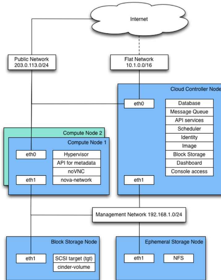
クラウドコントローラーでは、ダッシュボード、API サービス、データベース (MySQL)、メッセージキューサーバー (RabbitMQ)、コンピューティングリソースの選択を行うスケジューラー (nova-scheduler)、Identity サービス (keystone, nova-consoleauth)、Image Service (glance-api, glance-registry)、ゲストへのコンソールアクセス用サービス、ストレージリソースのスケジューラーを含む Block Storage サービス (cinder-api と cinder-scheduler) が動作します。
